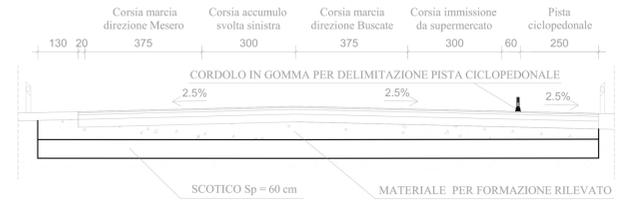
SEZIONE TRASVERSALE TIPO CON NUOVE CORSIE DI ACCUMULO, IMMISSIONE ET PISTA CICLOPEDONALE (SCALA 1:100)
